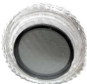
Afin de réaliser mon polariscope, j'ai acheté des filtres polarisants sur internet servant pour la photographie (attention, se procurer des filtres PL (polariseur linéaire) et non des CPL (Circular polarizing filter)). Ces filtres font 67 mm de diamètre et sont fixés sur une assise en métal rotative (très pratique pour les faire tourner). D'autres objets peuvent servir de polariseur comme des filtres se trouvant dans les écrans LCD, ou alors des lunettes de soleil, etc.
